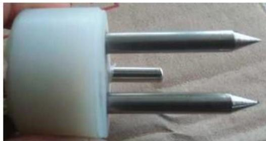
Gambar 1 Sensor Kelembaban dan Suhu Tanah pada Alat Ukur Kelembaban Tanah IOT
