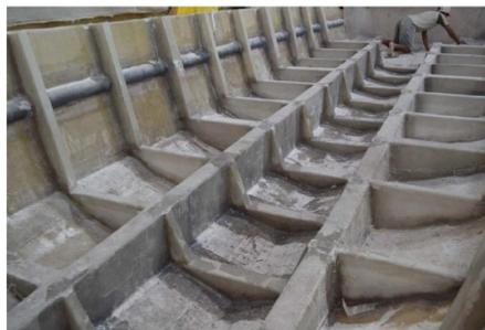
Gambar 1 Sistem Konstruksi Penegar pada Kapal *Fiberglass*
