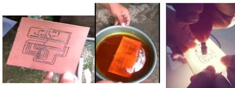
Gambar 1. Proses Pembuatan Manual Jalur PCB
