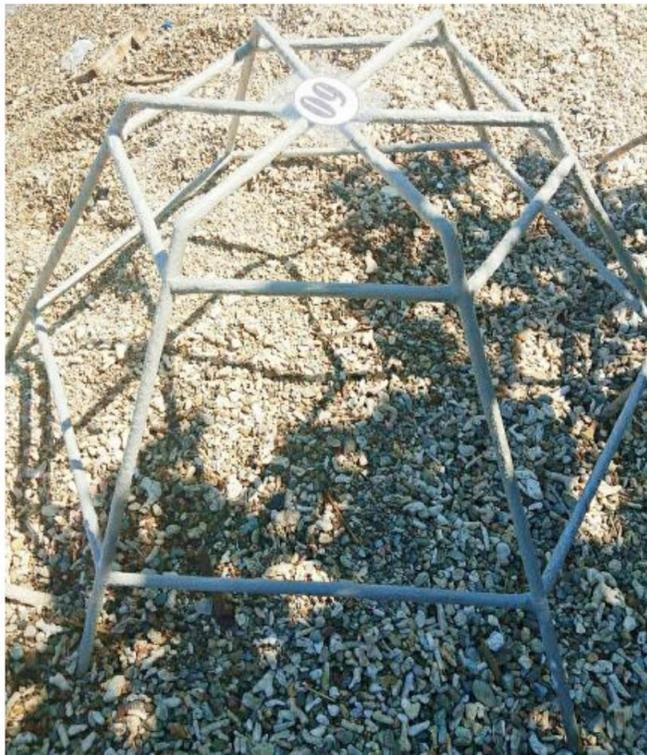
Gambar 1. Modul *Spider Web* yang dimodifikasi menggunakan lapisan semen
