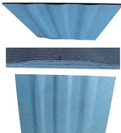
Gambar model uji prototipe Panel komposit dengan perkuatan tulangan bentuk trapesoid serat memanjang untuk bilah turbin
