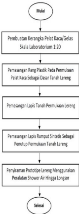
GAMBAR 2. PROSES PEMBUATAN PROTOTYPE LERENG TANAH & SIMULASI KELONGSORAN LERENG AKIBAT CURAH HUJAN
