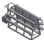
Gambar 3. Struktur rangka penopang Hidroponik tipe NFT menggunakan baja ringan dengan sistem pengalirannya
