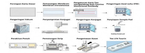
Gambar 1. Diagram Alir (flowchart) tentang Prosedur Pembuatan Rapid Test/ LFA
