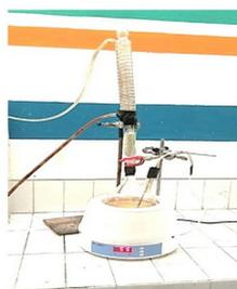
Gambar 1. Rangkaian alat ekstraksi PSO dengan metode Soxhlet
