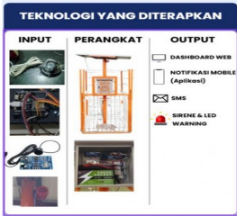
Gambar 1. Teknologi yang diterapkan pada alat pendeteksi tinggi muka air dan peringatan dini banjir berbasis Internet of Things.
