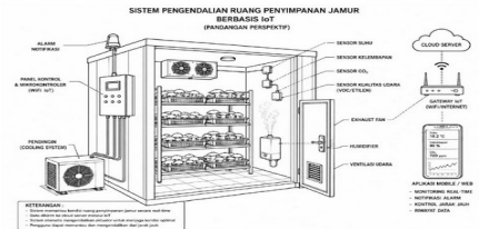
Gambar 1 SISTEM PENGENDALIAN RUANG PENYIMPANAN JAMUR BERBASIS IOT
